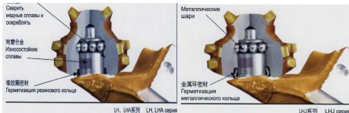
Рисунок 1.2 Узел герметизации опоры шарошки
