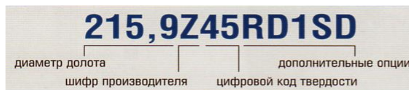
Рисунок 1.3 Расшифровка записи долота 215,9Z45RD1SD
